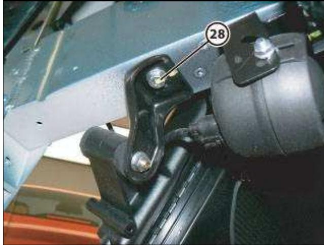
● 在左侧，拧紧将散热器总成固定到发动机副车架的螺钉 (28)。
