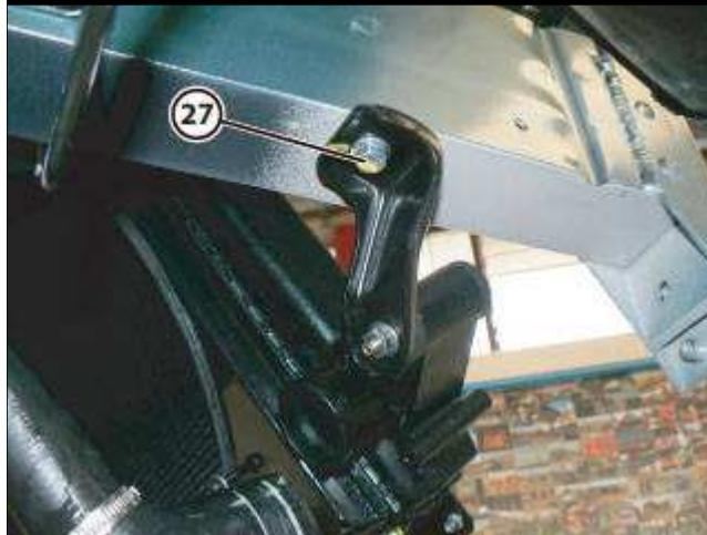
● 在右侧，拧紧将散热器总成固定到发动机副车架的螺钉 (27)。
