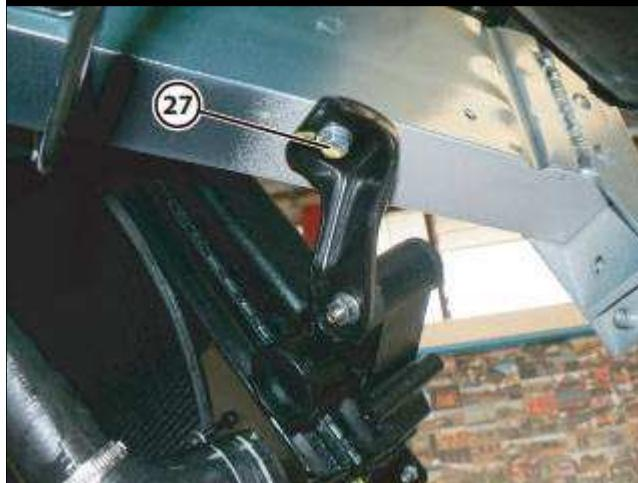
● 在右侧, 松开将散热器总成固定到发动机舱底盘的螺钉 (27)。
