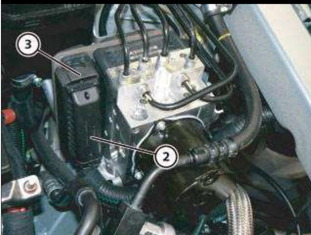
● 分离 ABS/ASR ECU 插头 (2), 提起安全杆 (3), 以便于接近管紧固夹。
