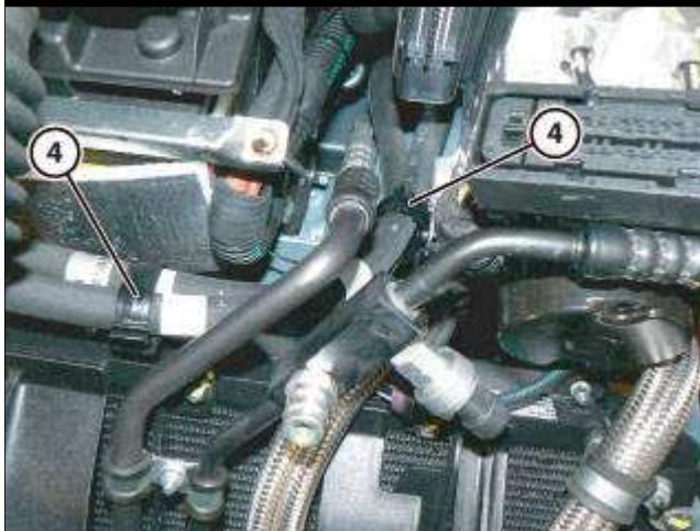
● 打开动力转向系统管上的塑料夹 (4)。
